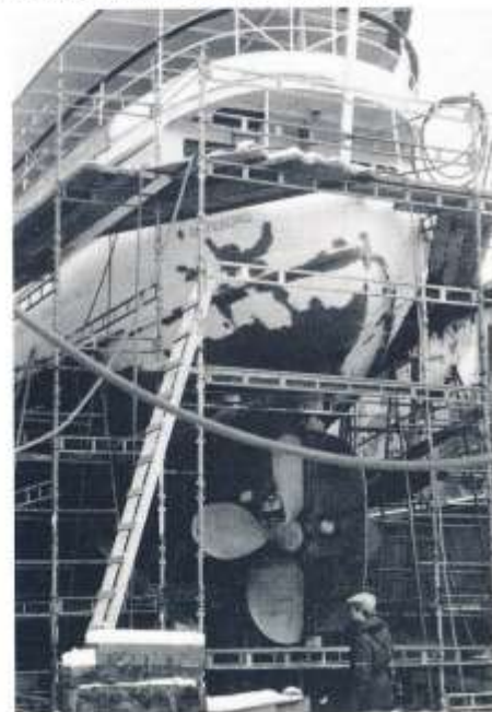
Ovan: Här har gammal plåt skurits bort på babordssidan i förskeppet. Bakom spanten skymtar durken i förliga inredningen. Nedan: Från dockans botten ser BOHUSLÄNS akterskepp imponerande ut.
